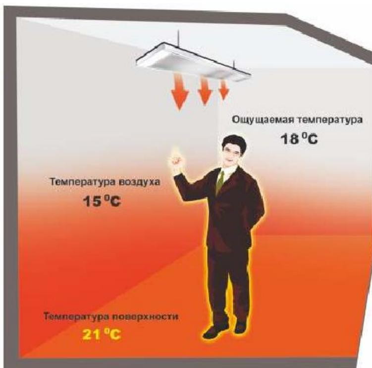
Рис 4а: Отопление с помощью потолочных панелей
