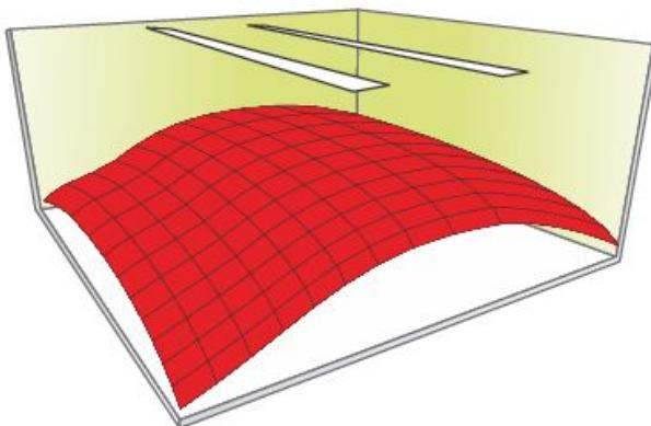
**Рис. 3** Две одинаковые панели, расположенные в центре помещения: неравномерное распределение интенсивности излучения с максимумом в центре помещения.
