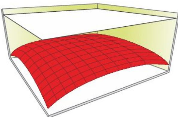
**Рис. 1** Понтию покрытый панелями потолок: неравномерное распределение интенсивности излучения с максимумом в центре помещения.
