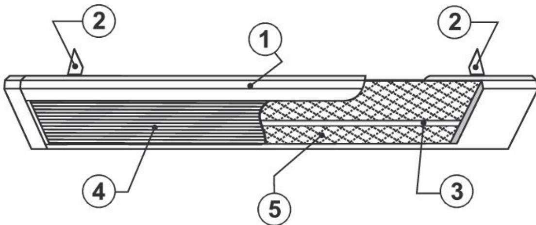
Инфракрасный обогреватель состоит из прямоугольного металлического корпуса покрытого жаростойкой краской (1), с элементами крепления к потолку (2). Низкотемпературный ТЭН (3) вмонтирован в теплоизлучающую пластину — высокоточный анодированный профиль из алюминия (4), высококачественный теплоизолятор (5).
