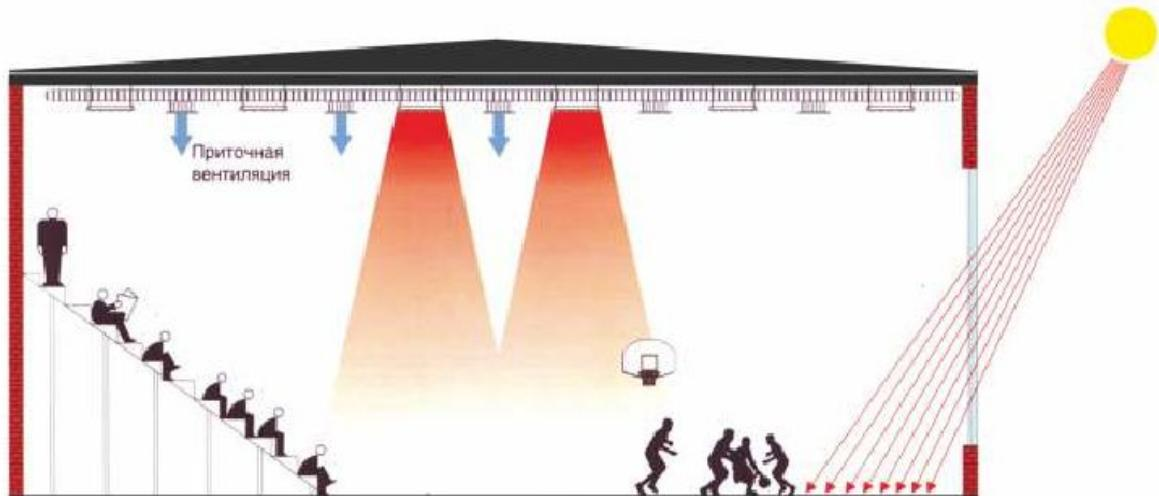
Рис.2: Оптимальное решение для спортзала, где предусмотрено большое количество мест для зрителей. Потолочные панели БІЛЮКС в комбинации с дополнительной системой вентиляции.
